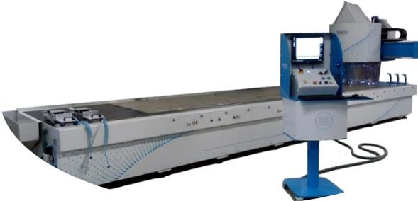
La 1200 Flexio est une machine **industrielle 5 axes** d'une grande **flexibilité** permettant d'usiner une grande variété de produits tels que portes, escaliers, châssis droits ou cintrés, agencement, etc. Ses dimensions permettent l'usinage simultané d'un grand nombre de pièces.
